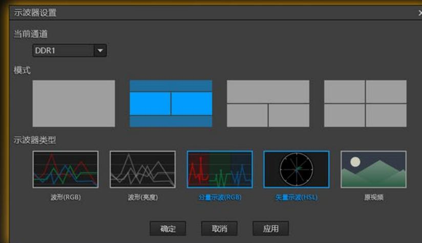
NSCaster MINI 2 利用波形图 (RGB/亮度)、分量 (RGB)或矢量 (YUV) 图的方式可视化视频的像素信息，有利于直观且准确地评估视频信号，可同时支持 PGM 或者通道启用示波器功能。
