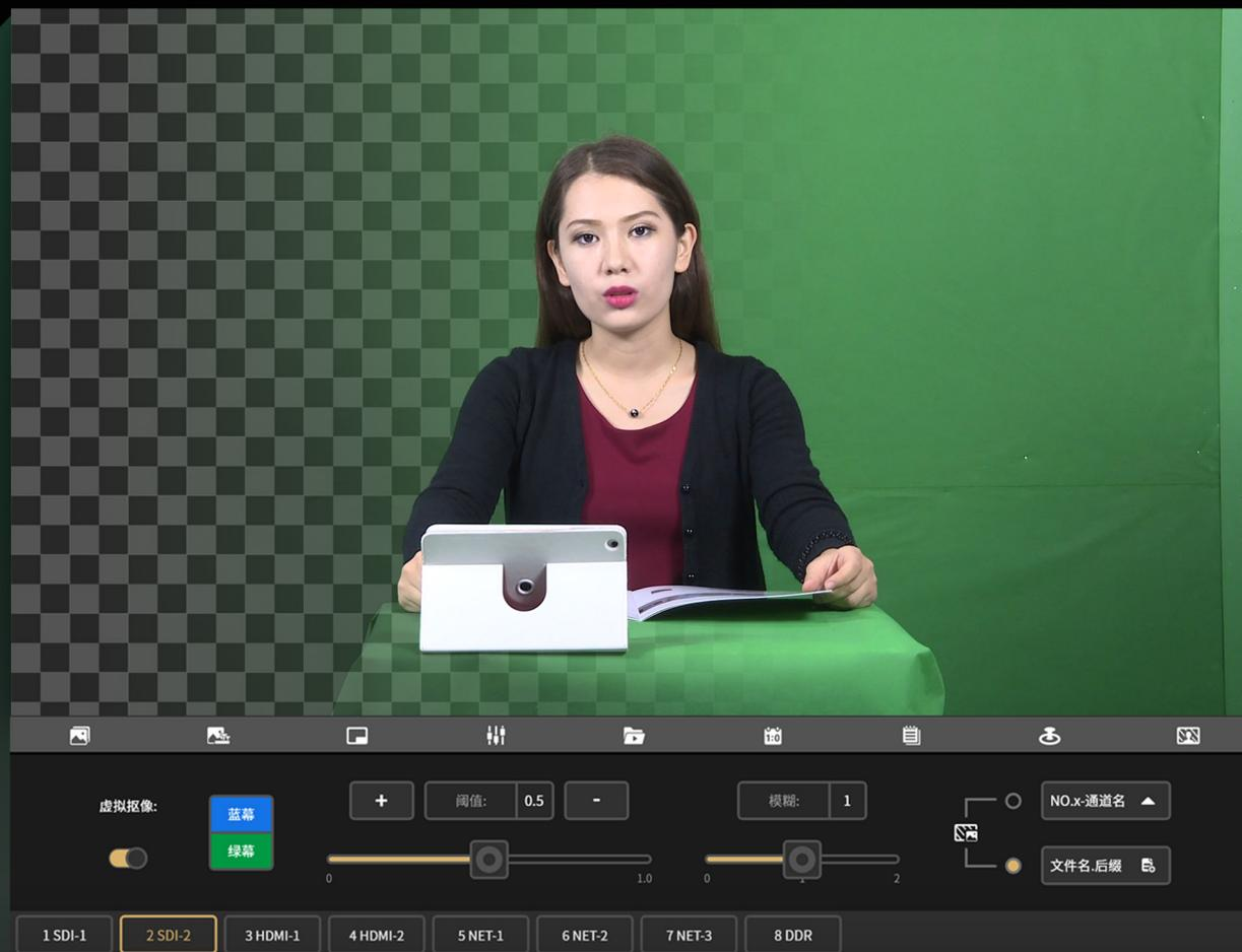
NSCASTER X2 MATE 支持实时的通道抠像功能，可以一键开启对当前蓝幕或绿幕画面进行高效的基于GPU加速的实时抠像工作，支持阈值、模糊等动态参数调整，支持视频或图片文件或者信号通道背景置入方式。
