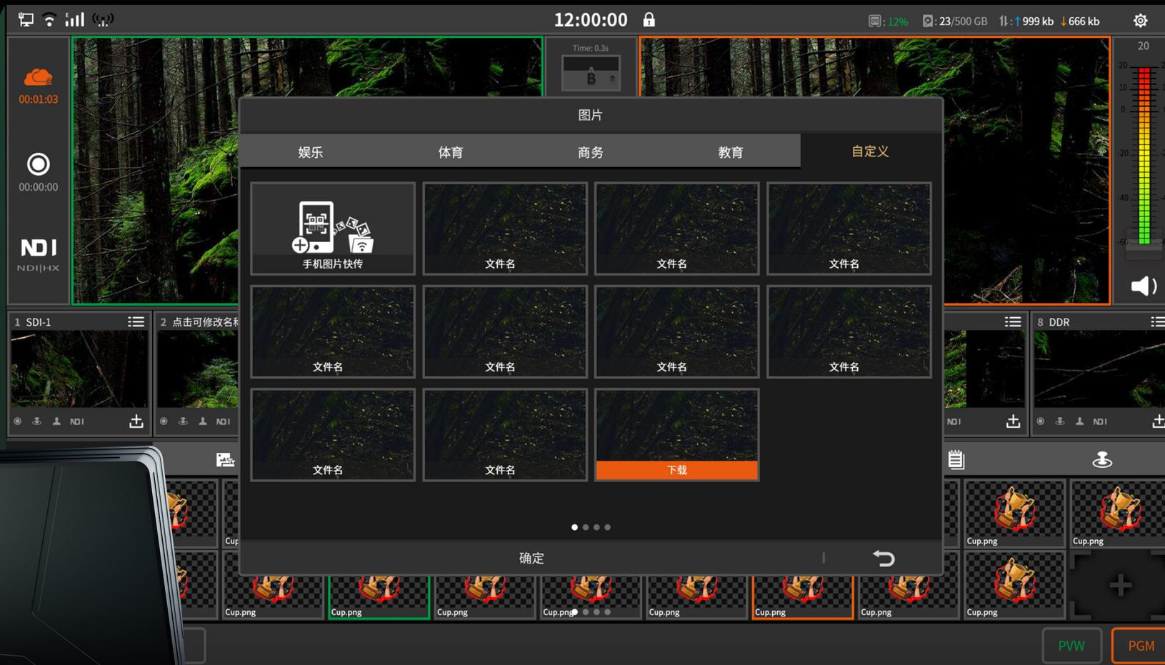
NSCASTER X2 MATE 内置手机同屏输入和图片快传功能，手机扫描设备二维码可以实现快捷的文字录入和图片素材传输导入。
