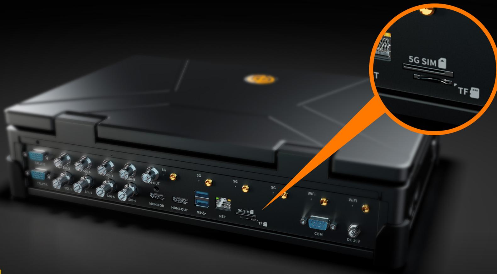
**NSCASTER X2 MATE** 内置5G SIM卡槽，支持5G NSA/SA、向下兼容4G全网通制式。可以在户外或临时会场等缺乏有线宽带的场所使用移动网络进行直播保障。
