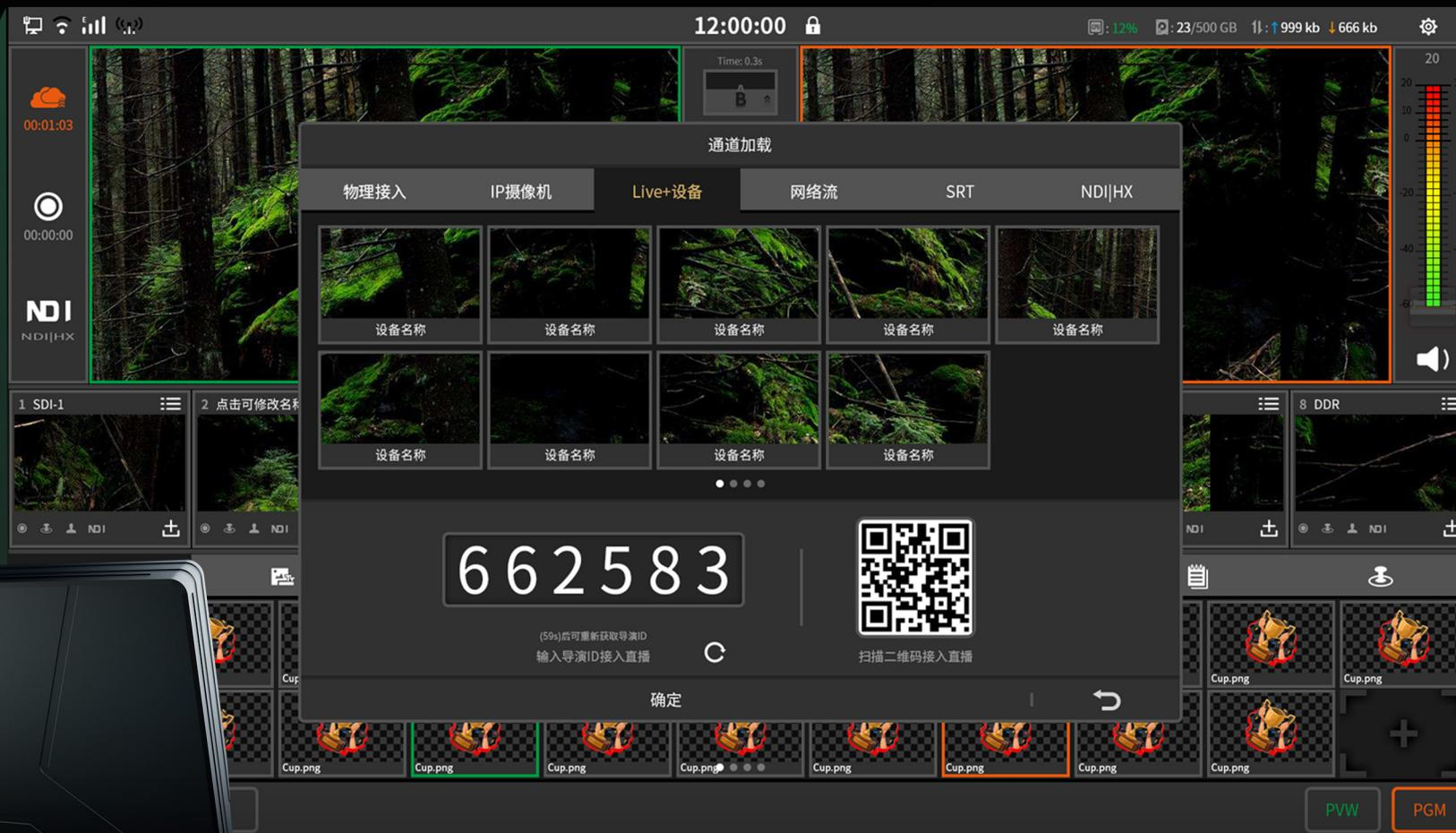
NSCASTER X2 MATE 搭载纳加软件LIVE+互联机制，通过纳加NDIP协议，智能手机、花火聚合编码器前端设备无需布线连接，只需扫描X2设备上的二维码或输入6位导演码，即刻实现前端设备与X2 MATE导播机的互联互通加入直播，让直播节目制作更简单、更快捷。
