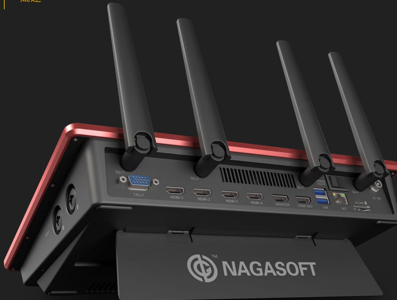
**NSCaster X2** 是一款嵌入式的8路导播平板，支持4K制式节目制作并推流录制。设备配备13.3英寸FHD触控显示屏，最高支持4路4Kp30或2路4Kp60物理输入；支持三种输入组合：SDI×4、HDMI×4、SDI×2+HDMI×2；支持众多主流格式流信号加载接入和LIVE+手机等设备互动接入。
