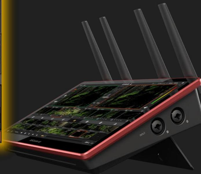
NSCASTER X2 拥有8路导播窗口，并且支持通道自定义；可以为每个导播窗口选择物理输入、IP摄像机输入及网络流等各种视频源的输入方式，能够满足各种直播需求。
